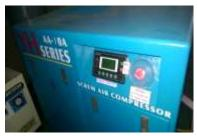
103-2-3 一體式機殼、液晶操控面板 及電腦控制均屬業界最高等 級入駐本校,有效節能並靜 音提供穩定氣壓。 ~沒本子計畫就沒有它~
